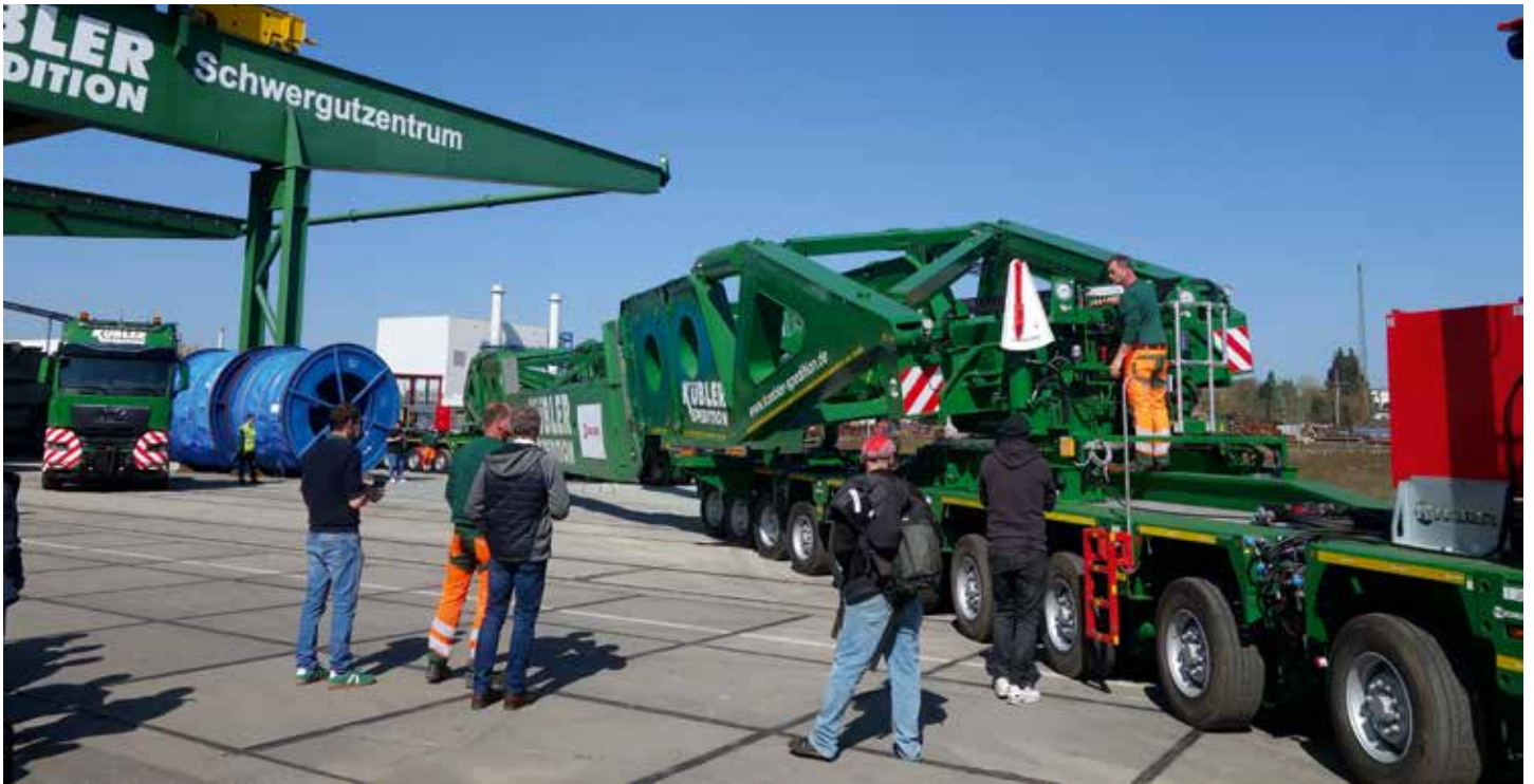
Die Brücke kann, wie hier zu sehen, um bis zu 8° zu beiden Seiten geneigt werden.
