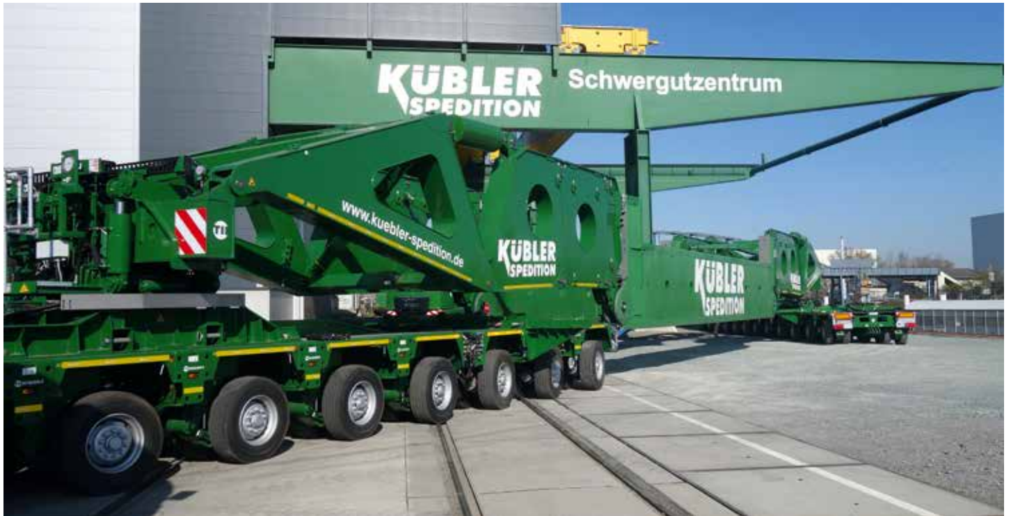
Um die Live-Demo durchführen zu können, war die STB 320 mit seitlichen Ladeträgern versehen.
