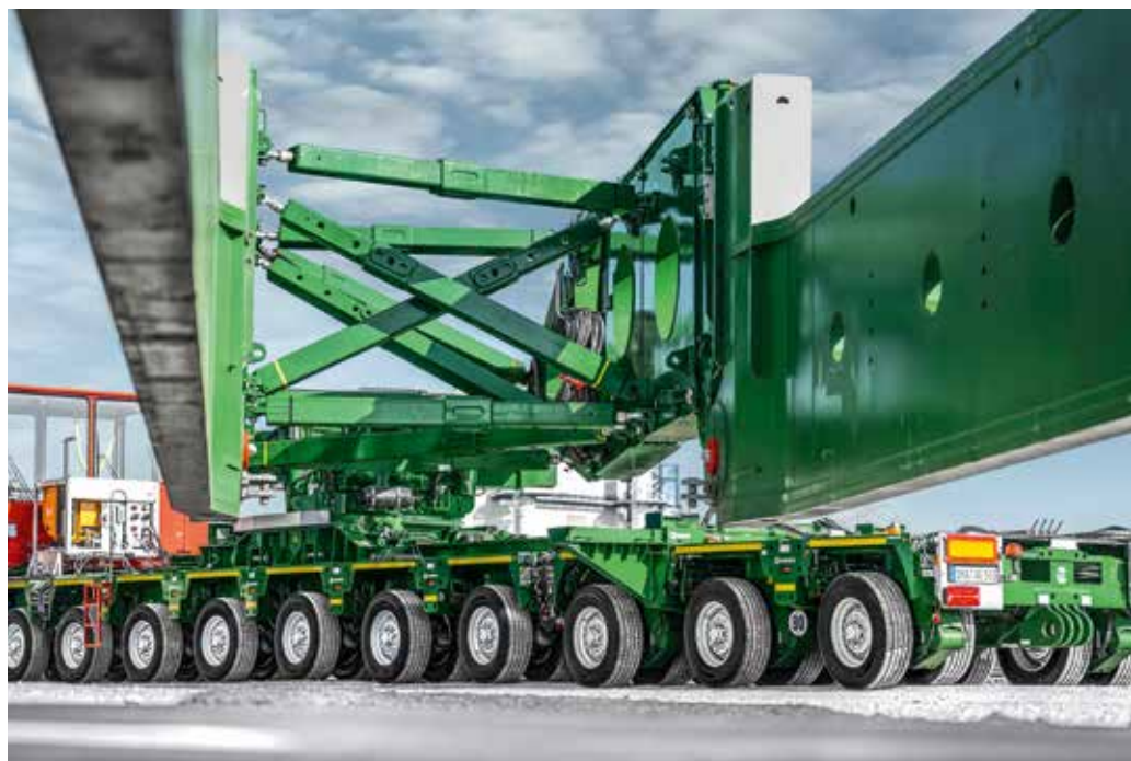
Dank hydraulischer Verbreiterung kann die Seitenträgerbrücke einfach an die Breite des zu transportierenden Transformators angepasst werden.
