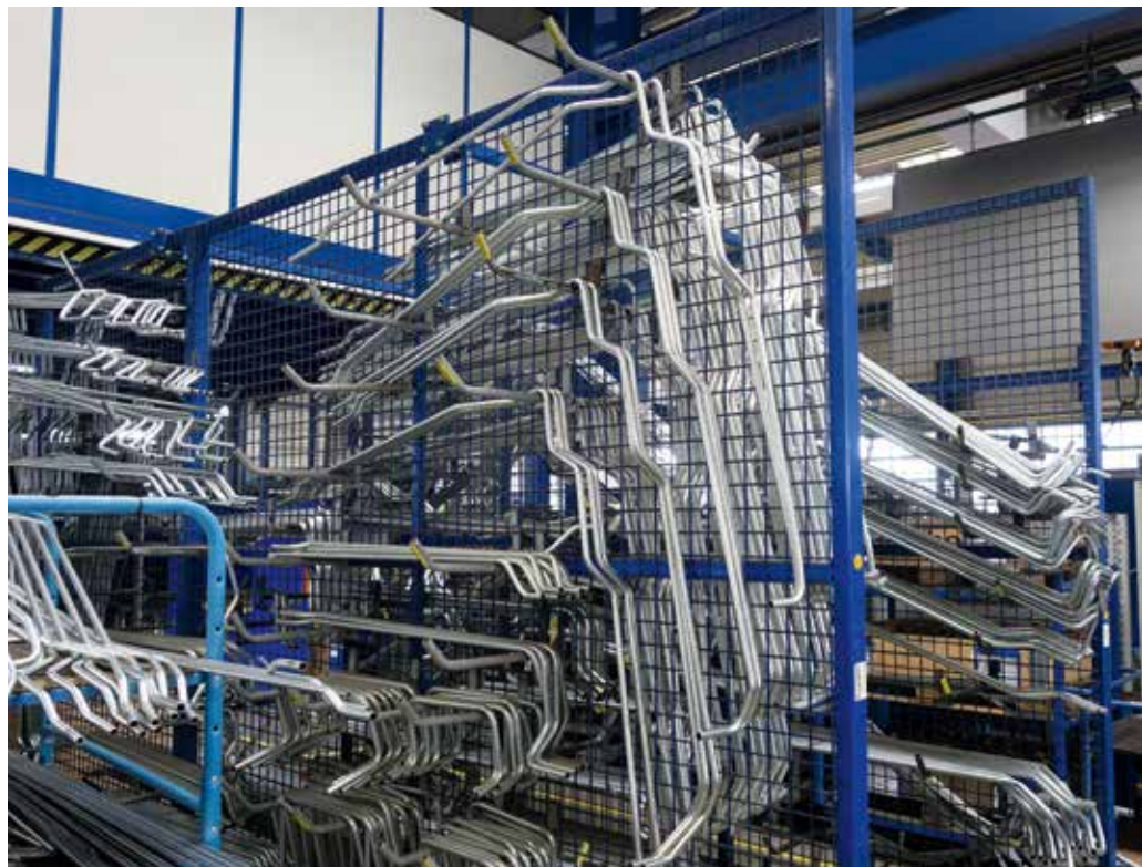
Schließlich warten die in Form gebrachten Leitungen auf den Einbau ins Fahrzeug.
