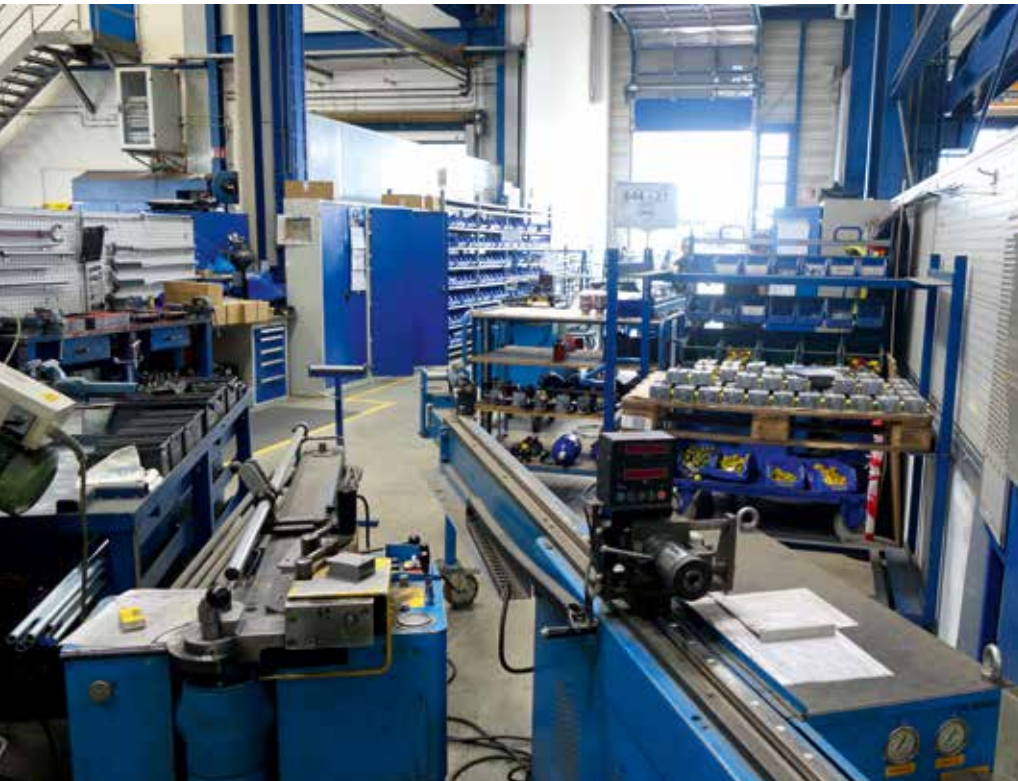
Das passende Werkzeug, um Rohrleitungen, beispielsweise für die Hydraulik, in die richtige Form bringen zu können.
