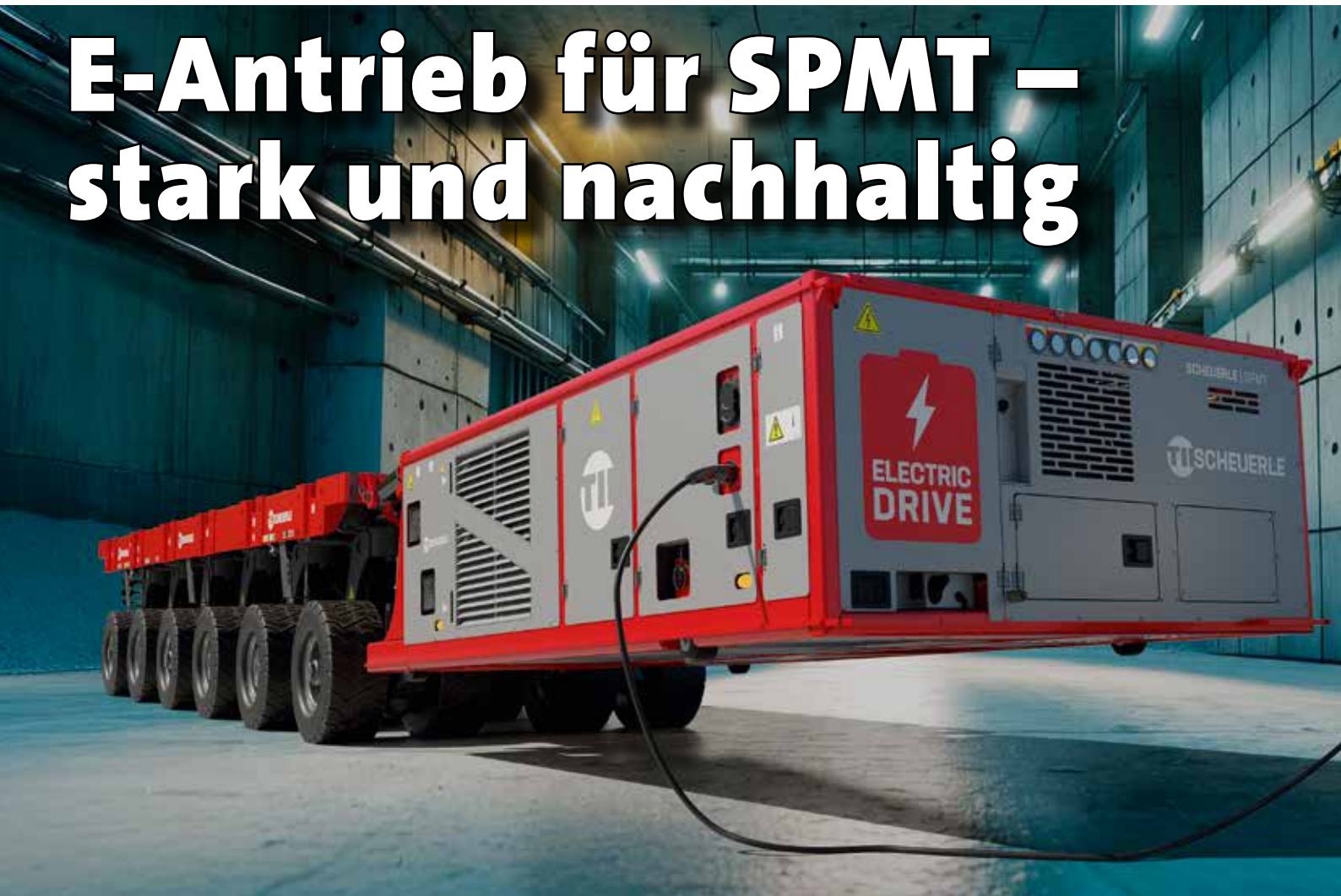
Ein TII SCHEUERLE SPMT mit ePPU beim Ladevorgang.
