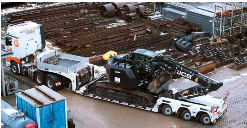
Beim Transport des großen JCB Raupenbaggers kann der Baggerarm in Bezug auf die Transporthöhe Probleme bereiten.
