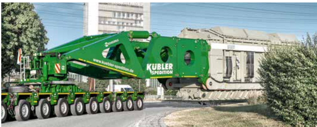
Die STB 320 wurde mit direkten Anschlagpunkten für die Transformatoren versehen, was im Bild gut erkennbar ist.
