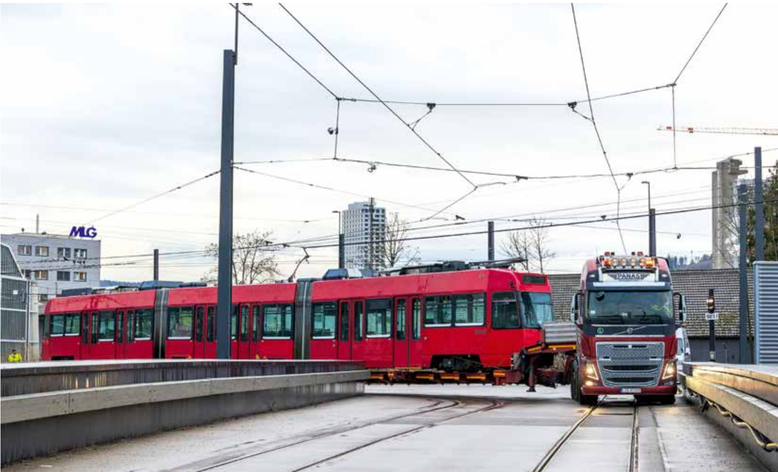
Bei der Ausfahrt über die Trambrücke muss weit ausgeholt werden, da der Trailer leider keine Ziehharmonikagelenke aufweist wie die Tram.
