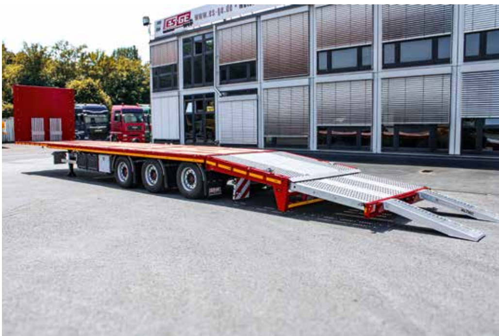
Für das Verladen von Maschinen mit sehr wenig Bodenfreiheit und geringerem Radstand ergänzen zusätzlich noch zwei lose Aluminiumrampen die Konstruktion.
