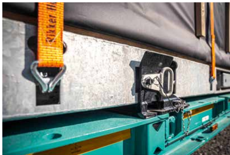
Zahlreiche Anschlagpunkte erleichtern die Ladungssicherung.
