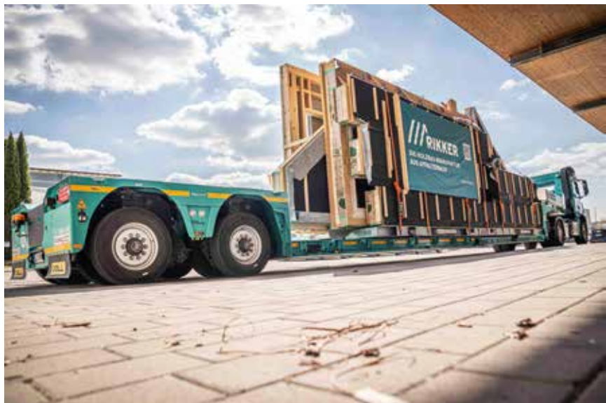
Die Ladefläche des Tiefbetts lässt sich bei Bedarf um bis zu 5.700 Millimeter teleskopieren, sodass flexibel auf unterschiedliche Längen des Transportgutes reagiert werden kann.
