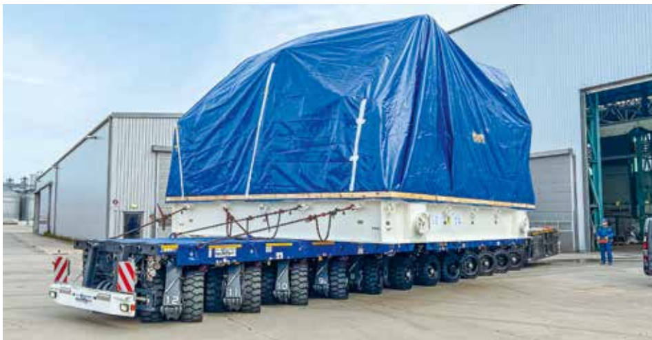
Nach der Schulung ging der Cometto SPMT auch gleich in den ersten Einsatz, bei dem eine 230 Tonnen Gasturbine umgesetzt wurde.
