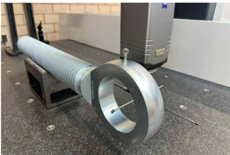
Größenvergleich kleiner und großer Gelenkkopf; Zeiss-Messmaschine. Foto: Carl Hirschmann GmbH
