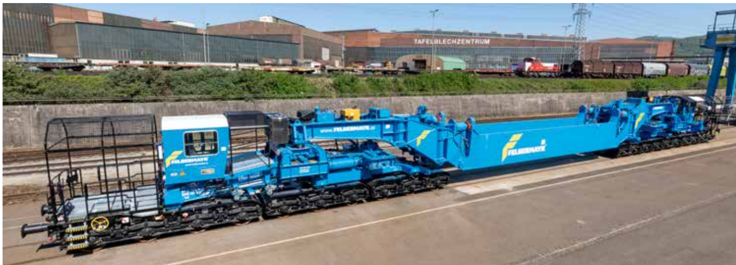
64 Meter lang, 630 PS stark, 32 Achsen: Tiefladewaggons von Felbermayr mit Gleitlagertechnik von Carl Hirschmann für Spezialtransporte auf der Schiene.
