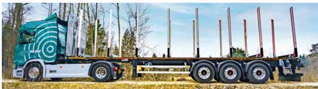
Der LOGO 12 besteht aus hochfestem und langlebigem Feinkornstahl mit niedrigem Eigengewicht.
