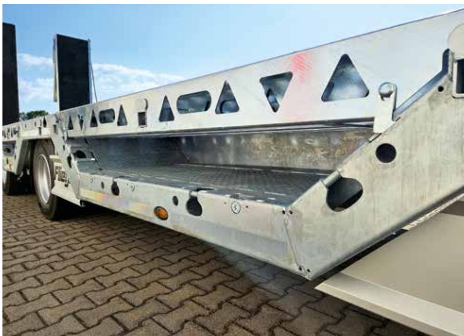
Werden die Radmulden nicht benötigt, können diese einfach abgedeckt werden, sodass eine ebene Ladefläche entsteht.
