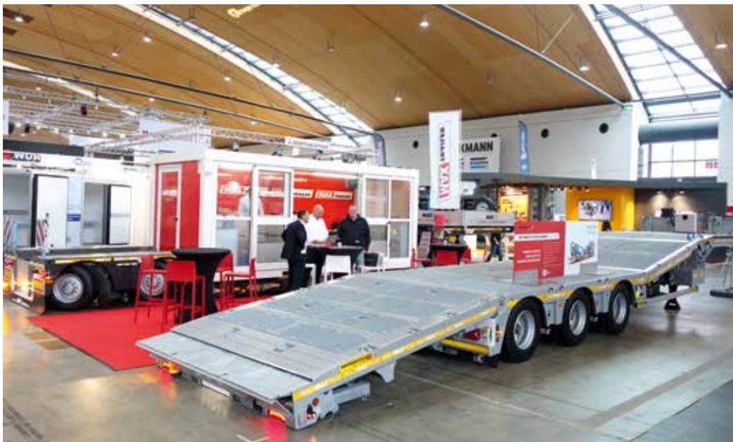
Feierte in Karlsruhe Premiere: der MultiMAX Plus im Bildvordergrund mit neuer Flip-Tail-Rampe, die über einen geringen Auffahrwinkel von lediglich neun Grad verfügt. STM-Bild
