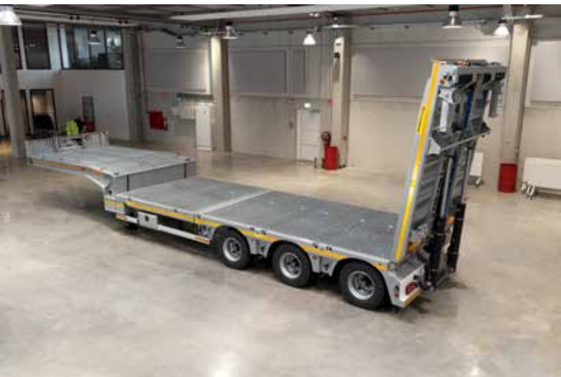
Ist die Flip-Tail-Rampe hochgeklappt, verkürzt sich die Gesamtlänge des Fahrzeugs um 2.400 mm.
