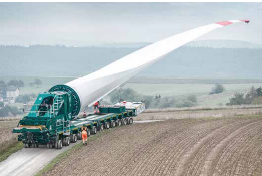
Eng, steil, kurvig – der SCHEUERLE BladeLifter G4 meistert auch schwierige Streckenführungen.
