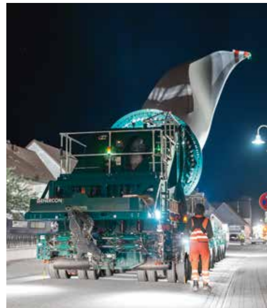
Zwischen Wohnhäusern und Straßenlaternen – dank der Schwenk- und Hubfunktion des BladeLifters bleibt selbst in engen Ortschaften genug Spielraum.
