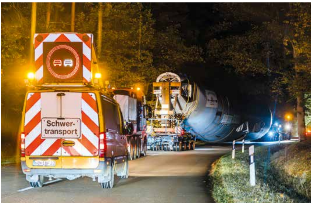
Durch eine innovative Modul-Achs-Nachläufer-Kombination konnte Gruber Logistics den Rumpf des Airbus A310 sehr tief über dem Boden transportieren und somit die Gesamthöhe des Transports auf 5,9 Meter senken.
