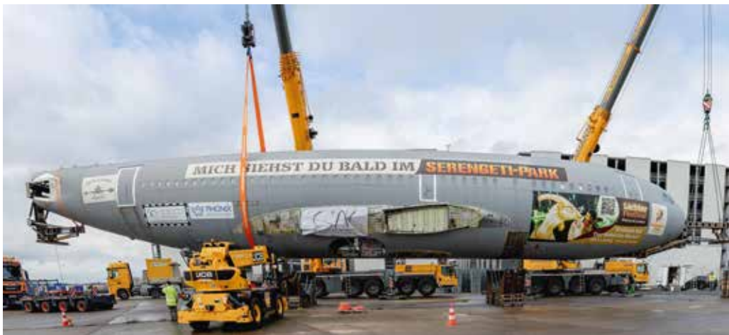
Der Rumpf des A310 hängt am Haken und ist für die Verladung auf die Modul-Achs-Nachläufer-Kombination bereit.
