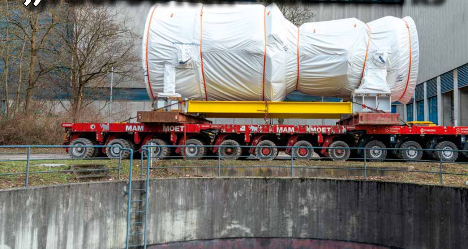
SPMT-Transport der Gasturbine über das Werksgelände.
