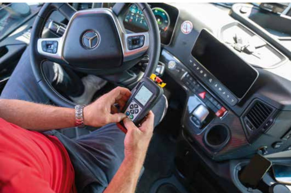
Eine weitere Arbeitserleichterung für den Fahrer: aus dem Fahrerhaus kann beispielsweise per einfachem Knopfdruck die Einspurung des Aufliegers erfolgen.
