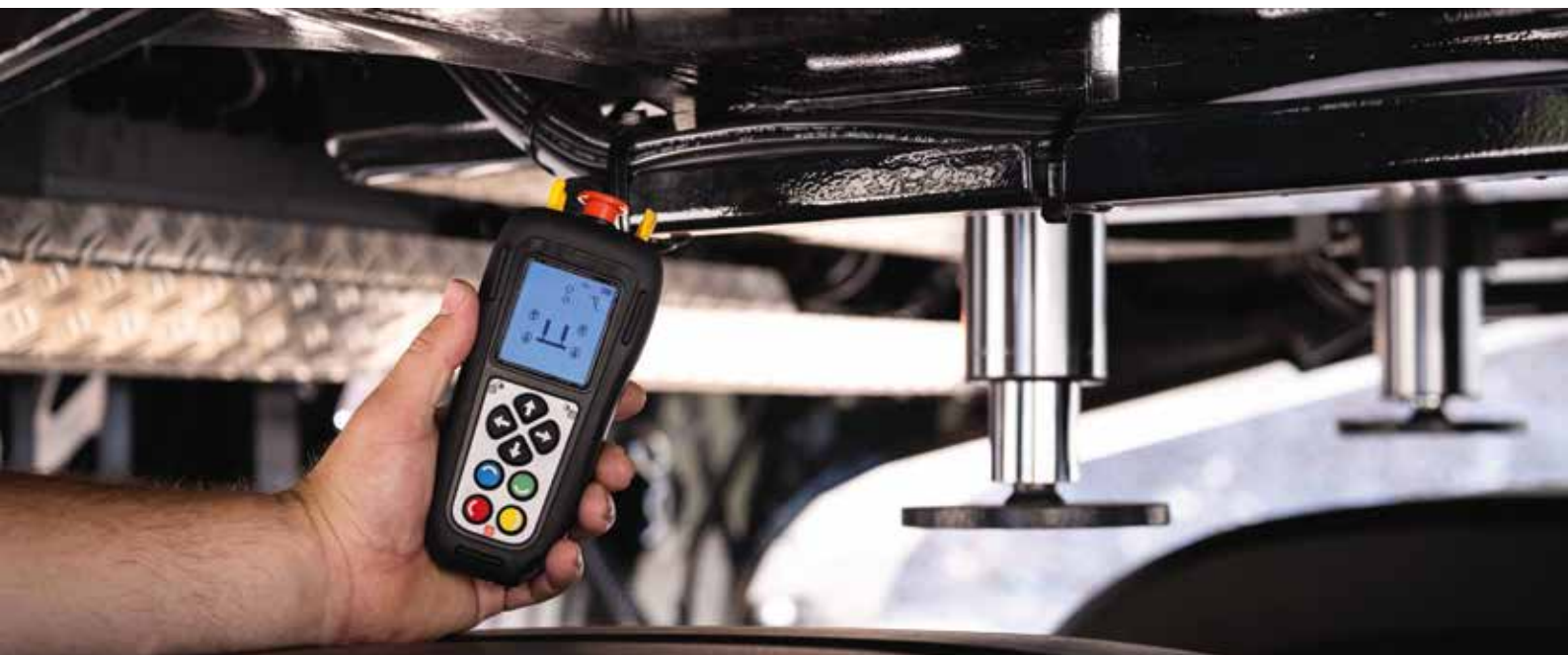
Sind die Abdrückzylinder nach dem Andocken des Schwanenhalses nicht wieder eingefahren, warnt das Assistenzsystem von DOLL den Fahrer. Dieser kann dann die Abdrückzylinder einfach per Knopfdruck einfahren.
