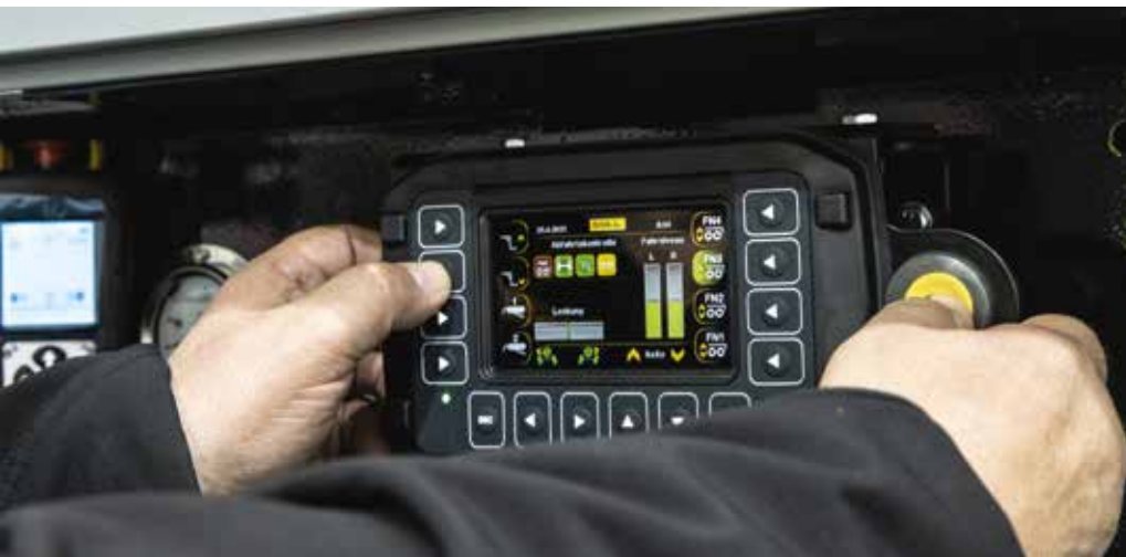
Die Assistenzsysteme von Doll können auch etwas ungeübteren Fahrern die Arbeit, beispielsweise bei der richtigen Positionierung der Last auf dem Tieflader, erleichtern.
