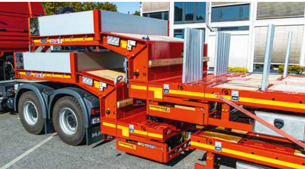
Für den Transport des zweiten MultiMAX musste das untere Fahrzeug nur leicht austeleskopiert werden. Die maximale Teleskopierbarkeit beläuft sich jedoch auf etwa 6.200 mm.
