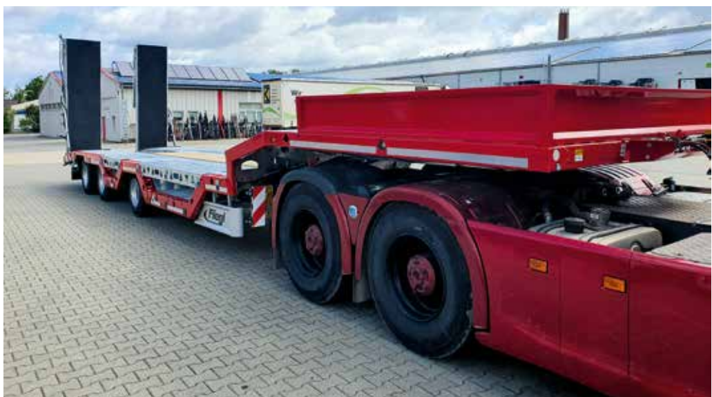
Die Abdeckungen über den Radmulden ermöglichen eine ebene Ladefläche. Ebenfalls im Bild gut zu sehen: Die Rampen mit dem Hartgummi-Belag.
