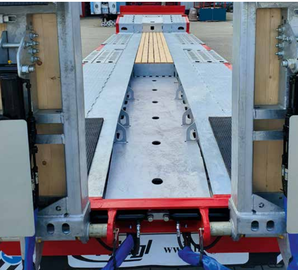
Für eine geringere Transporthöhe von Baggern ist der SDS 470 T mit einer Baggerstielmulde ausgestattet.
