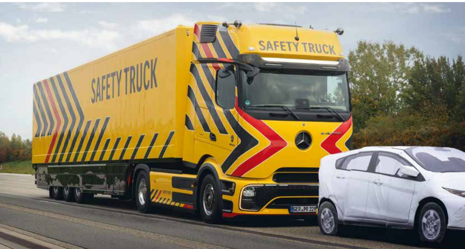
Active Brake Assist 6 Plus: Vor stehenden Fahrzeugen kann das System wie bisher bei Geschwindigkeiten bis über 80 km/h mit einer Vollbremsung bis zum Stillstand reagieren.
