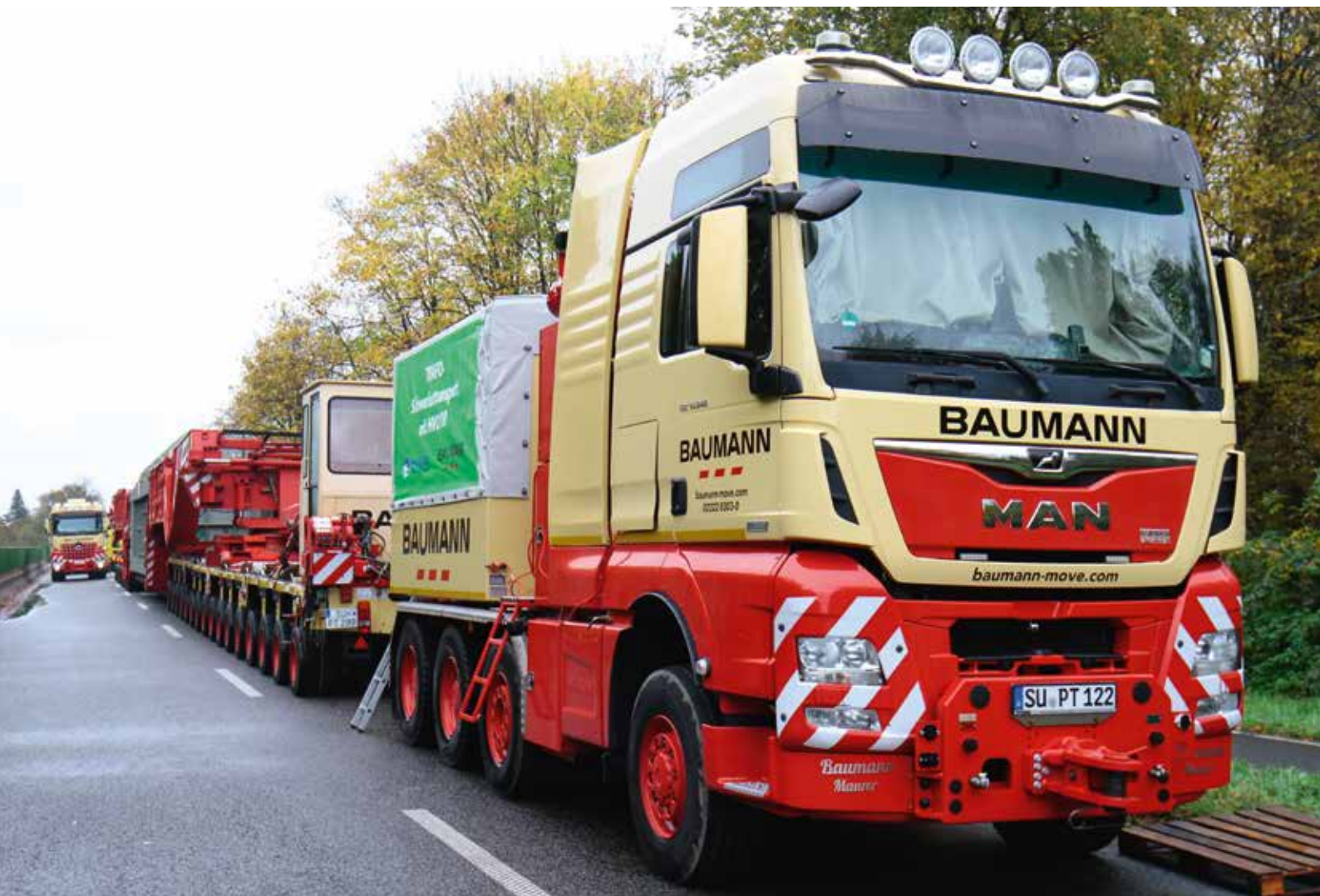
Der Transformator ist in der Kesselbrücke auf der 2 x 16-Achs-Kombination bereit für die Abfahrt. Im Hintergrund kommt die zwei mit HVO betankte Schwerlastzugmaschine, welche die Zug-/Schub-Kombination vervollständigt.
