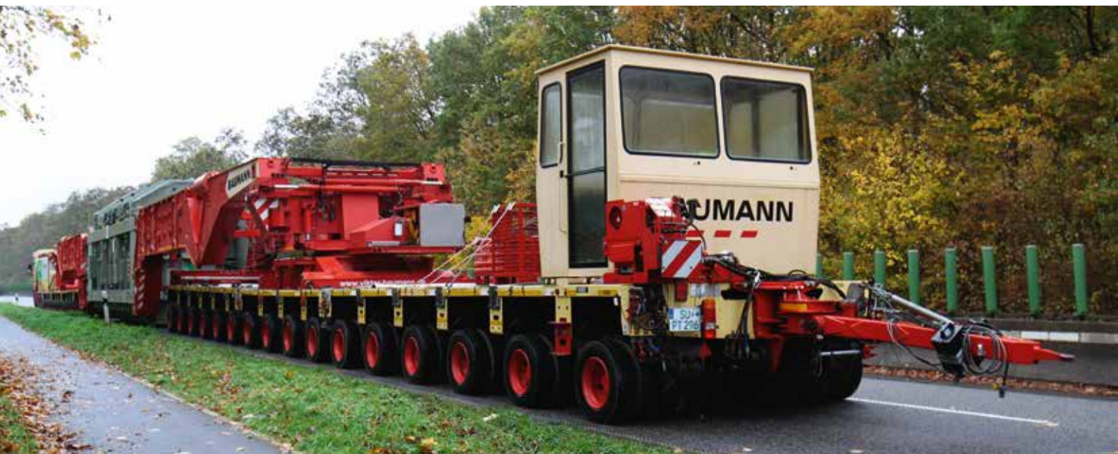
Brachte es auf eine beachtliche Länge: die komplette Transporteinheit für einen Trafo.
