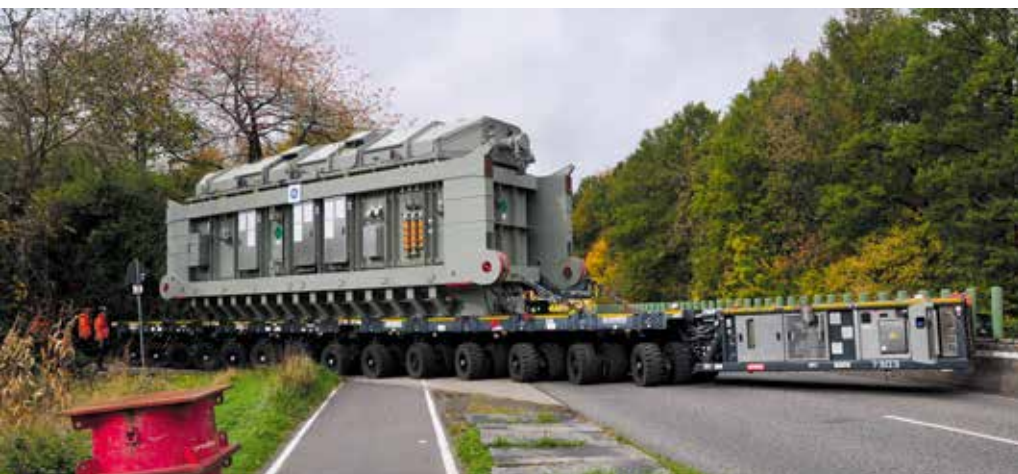
Auf den SPMTs geht es bis zur Kesselbrücke, wo der Transformator dann eingeschnabelt wird.
