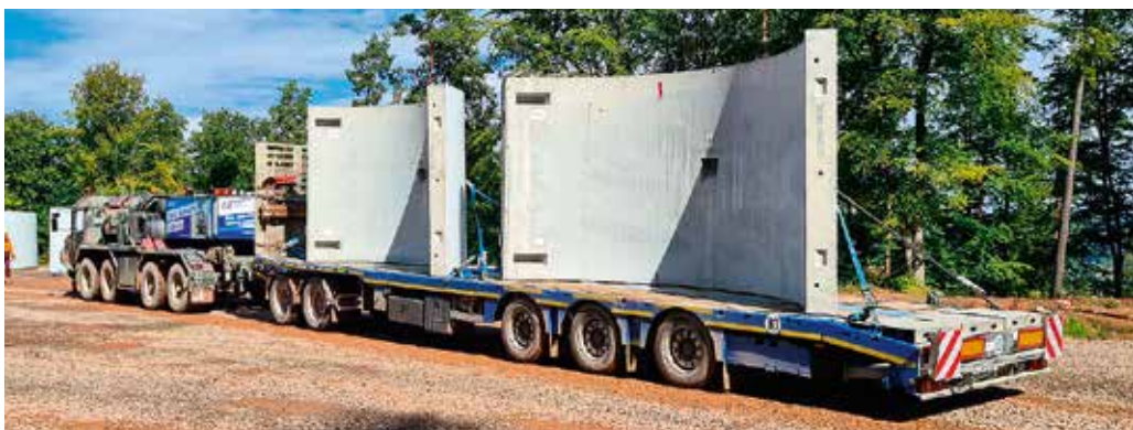
Der Fliegl TPS 118 mit Transportgut hinter dem Faun Schwerlasttransporter.
