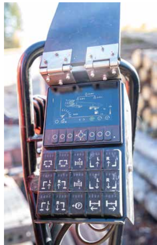
Auch auf dem Display direkt am Kran werden dem Fahrer die tatsächlichen Achslasten direkt angezeigt.
