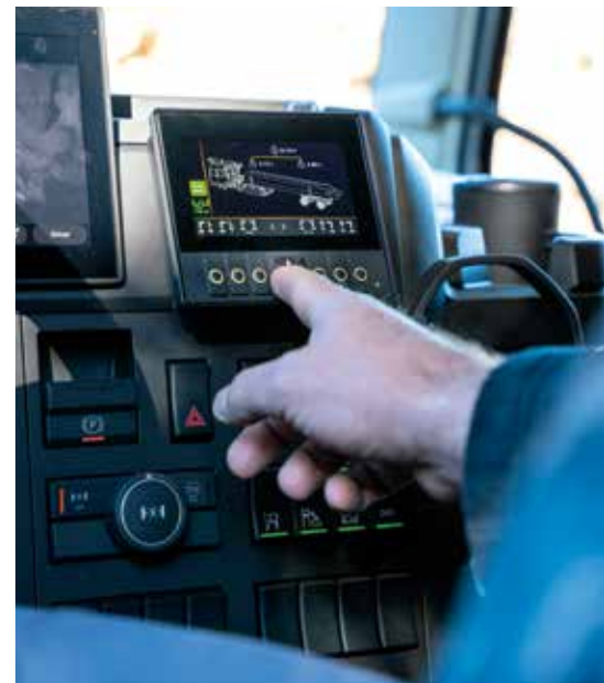
Über das 7-Zoll-Farbdisplay des digitalen Assistenzsystems DOLL control im Fahrerhaus hat der Bediener alle wichtigen Funktionen im Blick.
