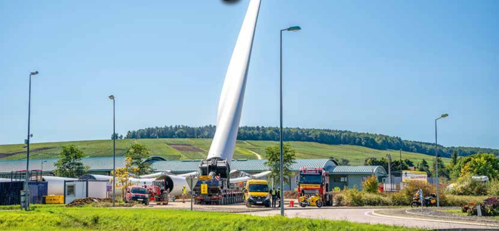
Der BladeMAX1000 mit dem montierten Rotorblatt ist abfahrbereit.
