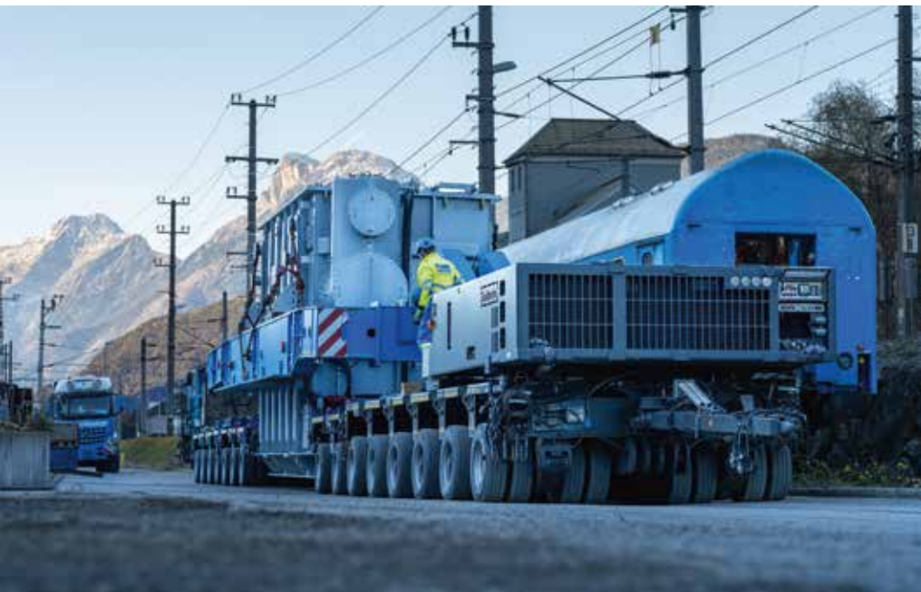
Bereit zur Abfahrt: 140 t schwerer Transformator für Kühtai 2.
