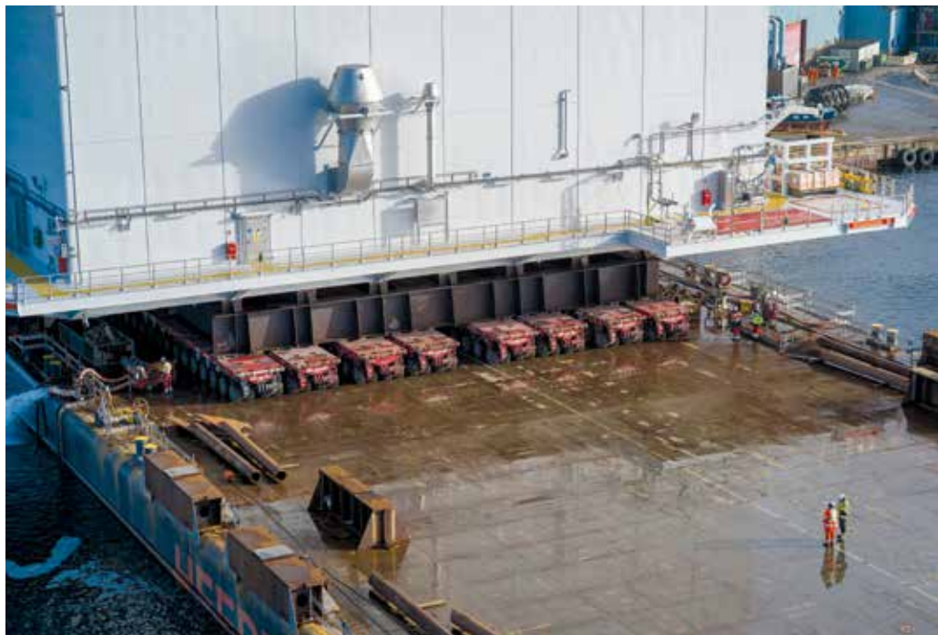
... bis zu 344 Achslinien an SPMTs benötigt.
