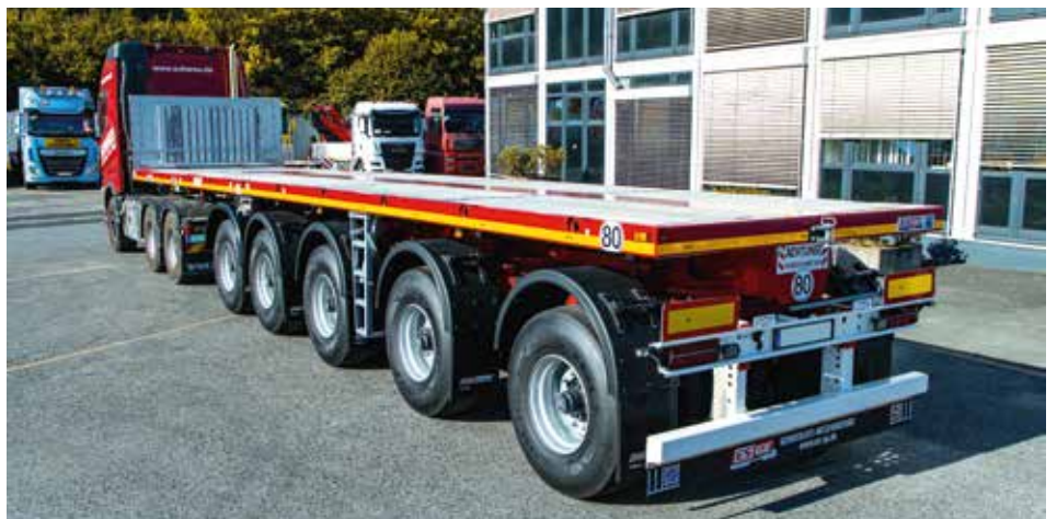
Der 5-Achs-Ballastauflieger des Typs MAX410 wurde speziell für den Transport von Kranballast entwickelt.
