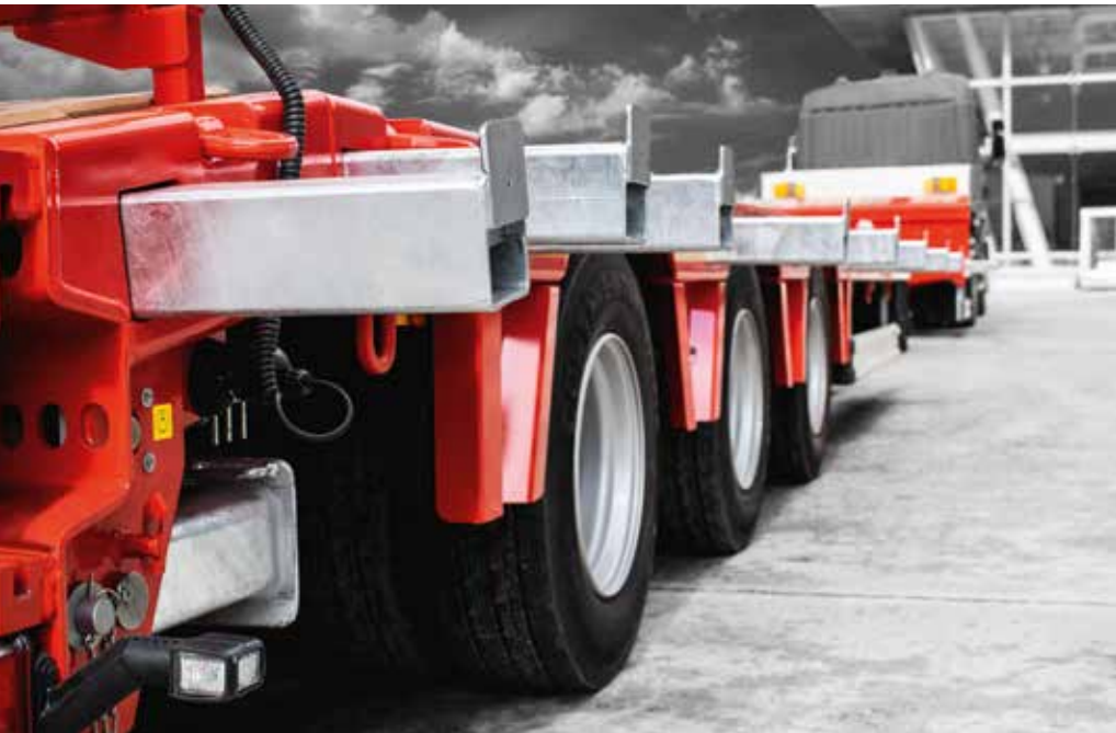
Für etwas breitere Ladung sind die Tieflader verbreiterbar.
