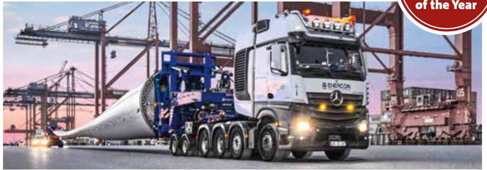
Mit dem SCHEUERLE RBTS verlassen die über 85 Meter langen Rotorblätter sicher verladen den Hafen von Wilhelmshaven.
