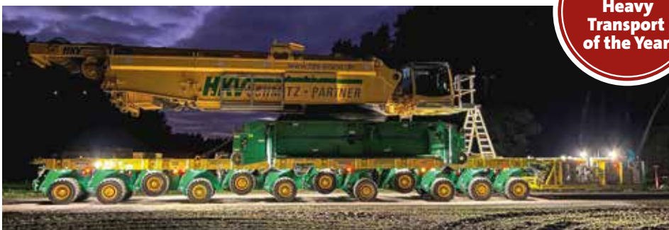
Wurde als erstes zum nächsten Einsatzort gebracht: der Ober- und Unterwagen des Liebherr Raupenkran. Dank Night-Light-Kit war der Transport auch in der Nacht problemlos.
