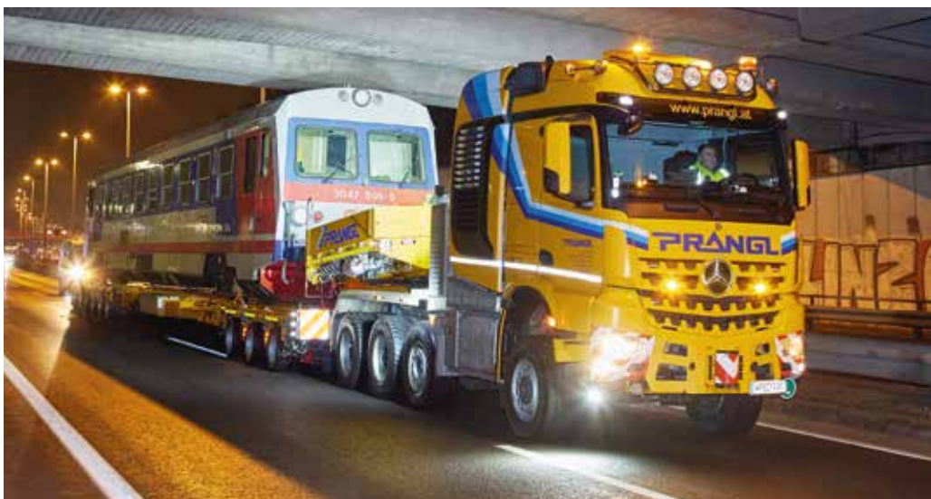
Um unter der Brücke durchzufahren, wurde das 9-achsige Transportfahrzeug abgesenkt.
