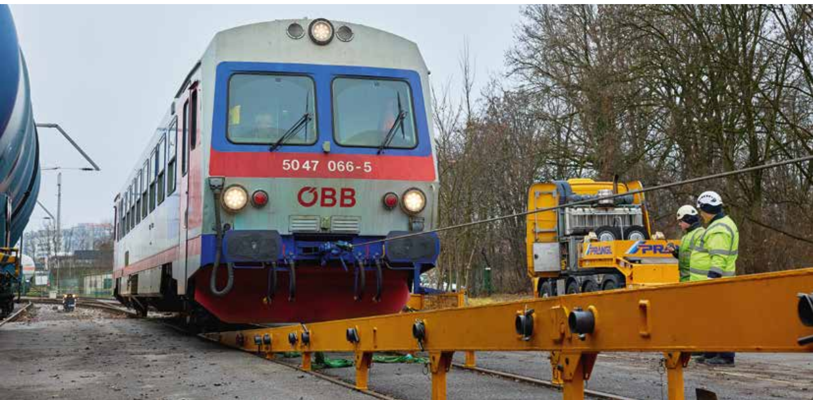
Der Triebwagen wird über die Rampe mittels Seilwinde auf das Schienen-Transportfahrzeug verladen.
