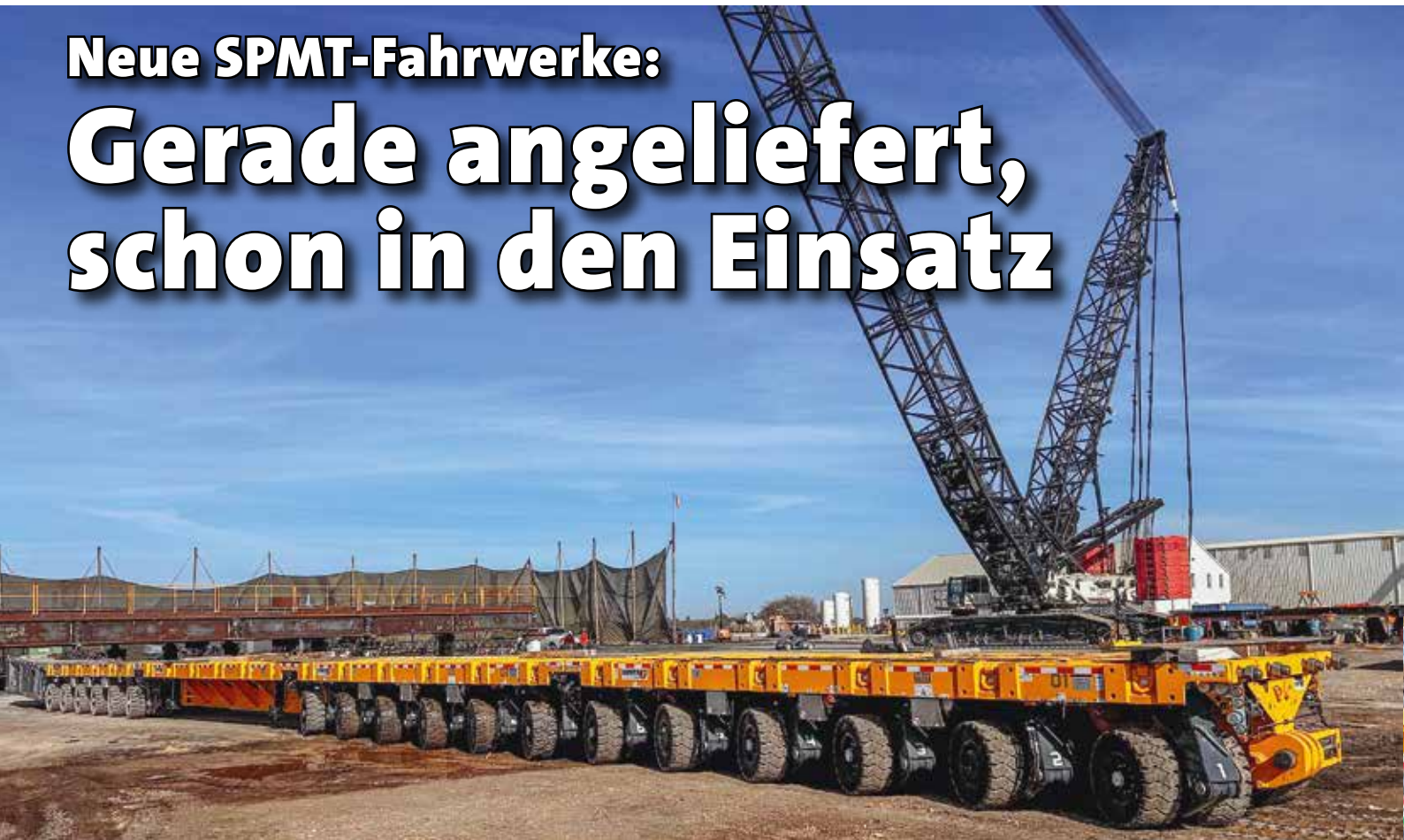
State Service aus Ingleside, Texas, erhielt im Januar 2026 vier 6-Achs-SPMT-Fahrwerke, sechs 8,40 Meter lange Spacer sowie eine Power Pack Unit mit 368 kW.
