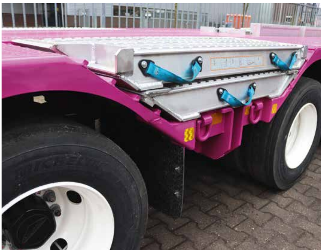
Die geteilten Aluminiumeinsätze verdecken komplett die Radmulde, sodass eine ebene Fläche entsteht.
