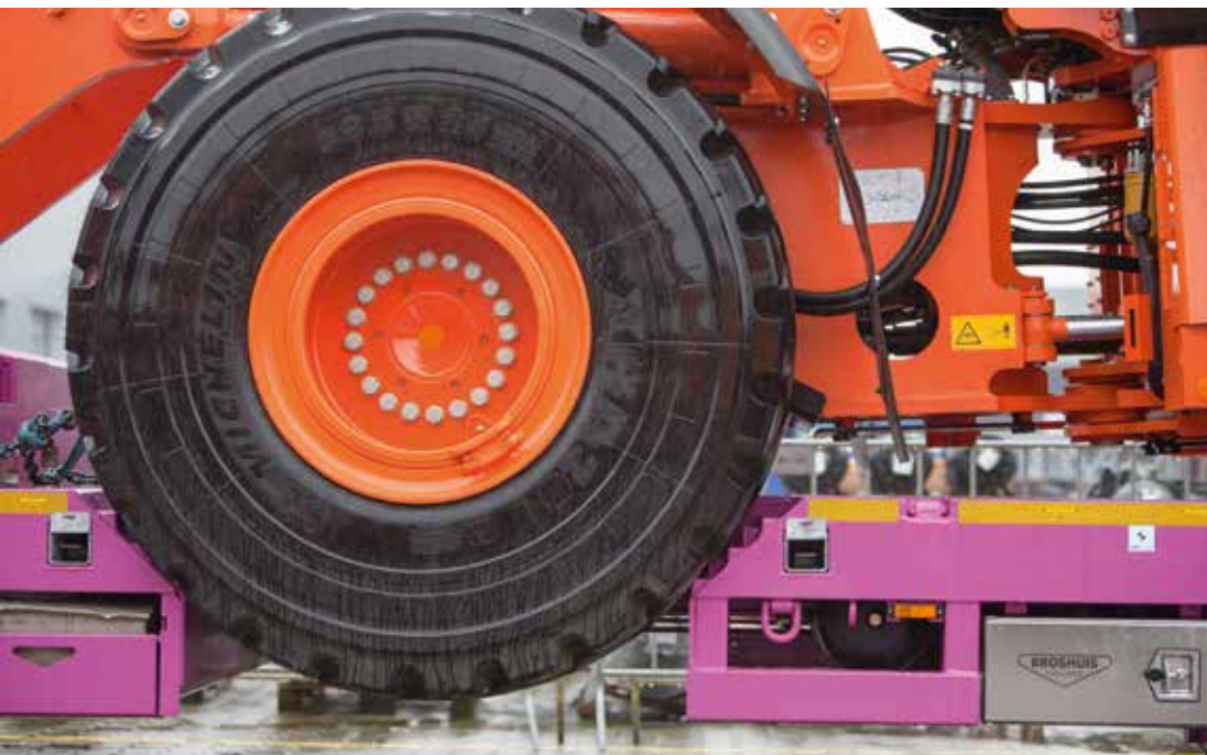
Komplett geöffnete Radmulde: Der Reifen sinkt tief ein, wodurch die Transporthöhe reduziert wird.
