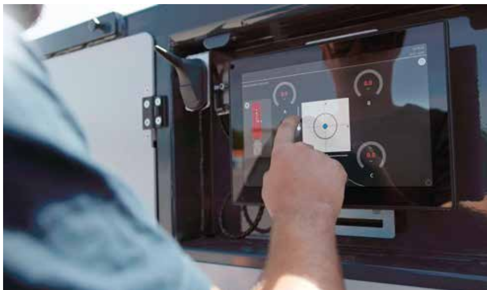
Der COG Easy Mode macht Schwerpunktverläufe transparent – am Fahrzeug sowie optional über SCHEUERLE Connect mit Live-Übertragung der Displayinhalte.
