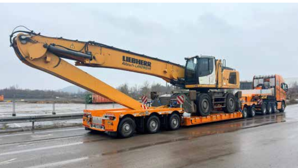
Die Baggerstiellmulde verringert die Transporthöhe.
