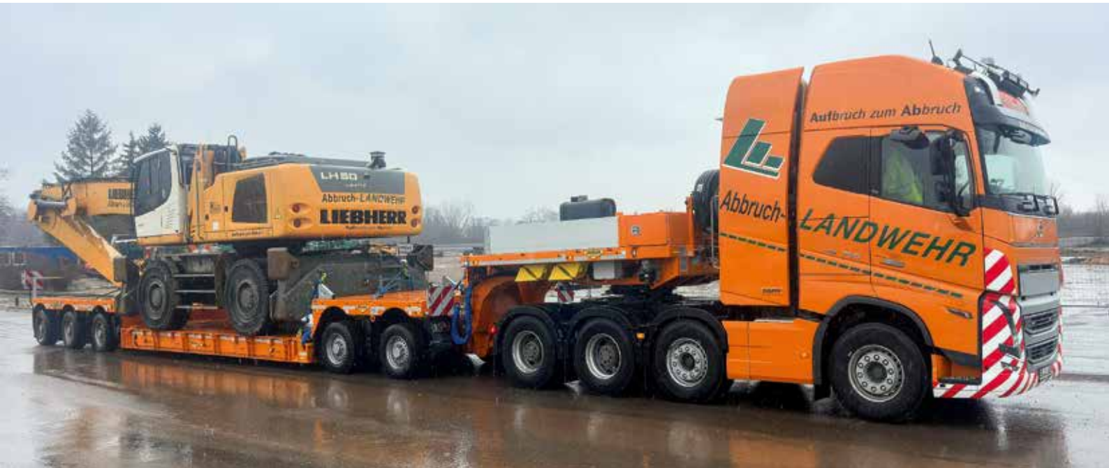
Beim Transport eines Radbaggers kommt das Tiefbett in der 2+3-Dolly-Konfiguration zum Einsatz.
