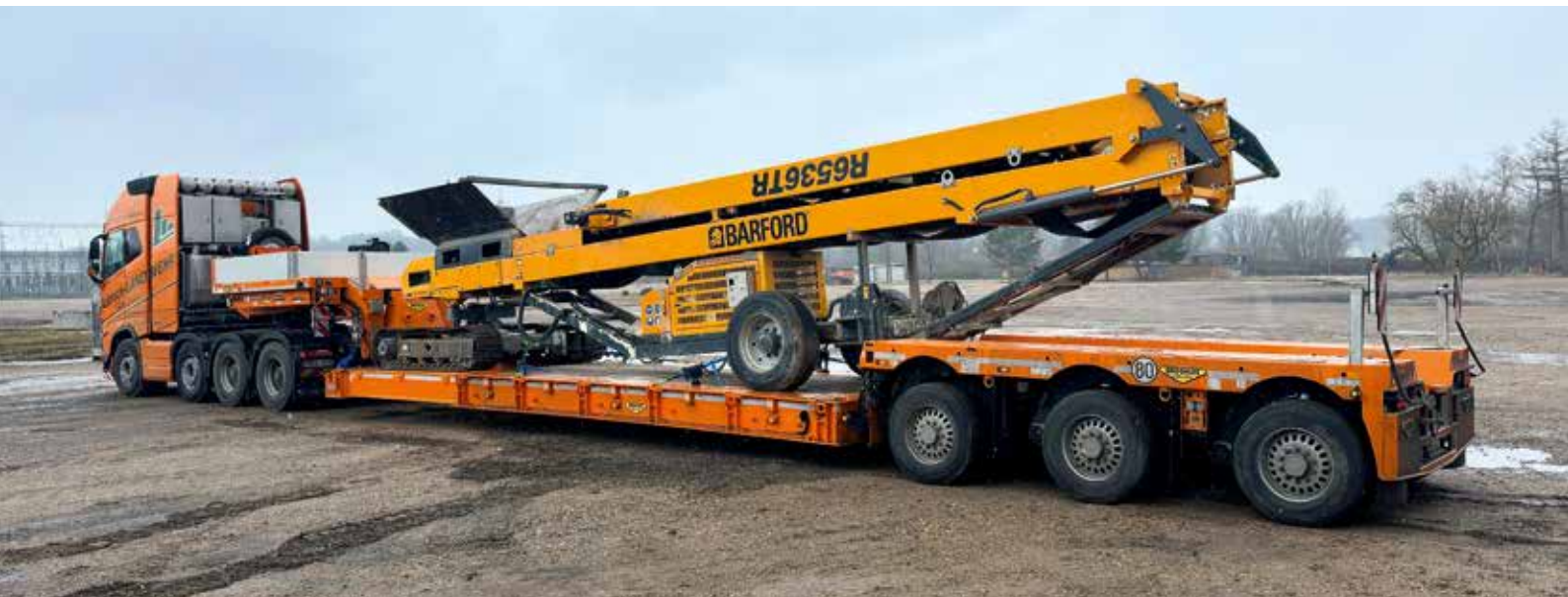
Auch lange Baumaschinenteile können mit dem Broshuis-Tiefbett problemlos gemeistert werden.
