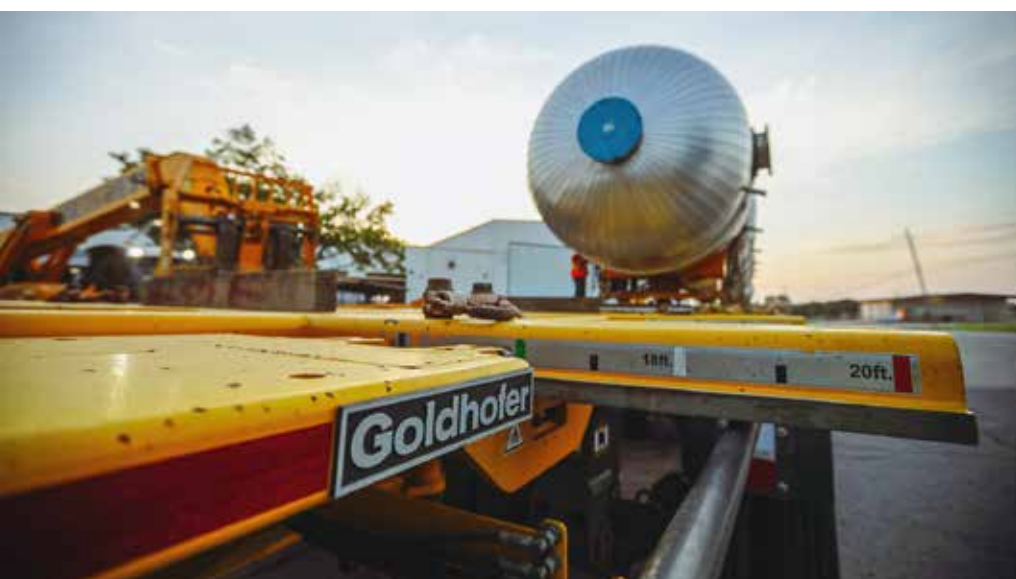
Für den THP/DC ist es durch flexible Breitenanpassung unter Last ein Leichtes, verschiedensten regionalen Gesetzgebungen zu begegnen.
