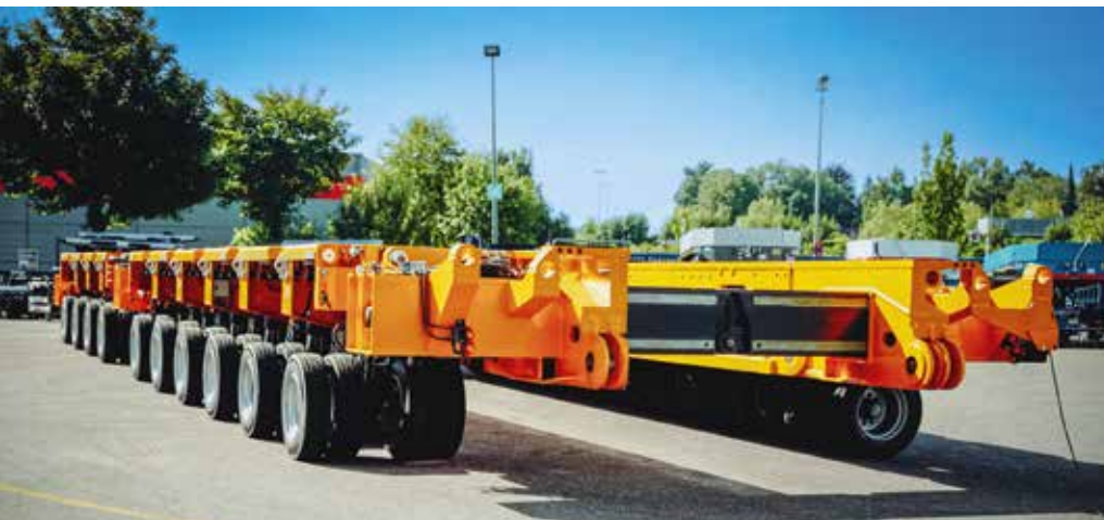
PST/SL-E split in Aktion: Flexible Anpassung der Breite zwischen 3.000 und 5.100 mm in weniger als 5 Minuten.
