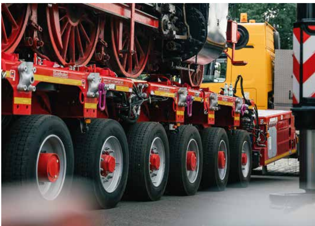
Achslasten bis zu 60 t bei luftgefüllten Reifen ohne TPMS und ohne Laufleistungsbeschränkung: Der neu gedachte PST/ES-E (315) von Goldhofer.
