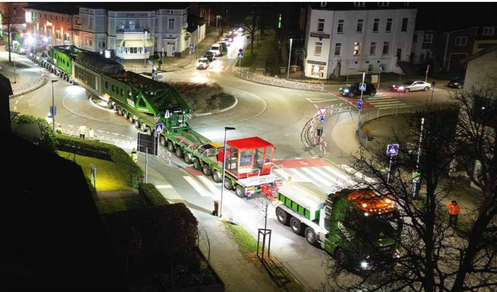
Die Mitte des Kreisverkehrs war halbseitig mit Stahlplatten überbaut, sodass das 529 Tonnen schwere Gespann den Kreisverkehr gerade überfahren konnte.
