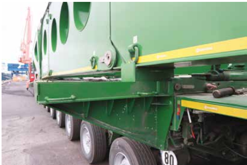
Die Seitenträger können hydraulisch an die Breite des zu transportierenden Trafos angepasst werden, sodass ...
