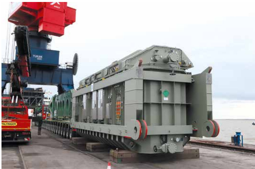
Die erste Seite des auf Holzbohlen abgesetzten Transformators wird von der Kubler-Seitenträgerbrücke STB 320 aufgenommen.
