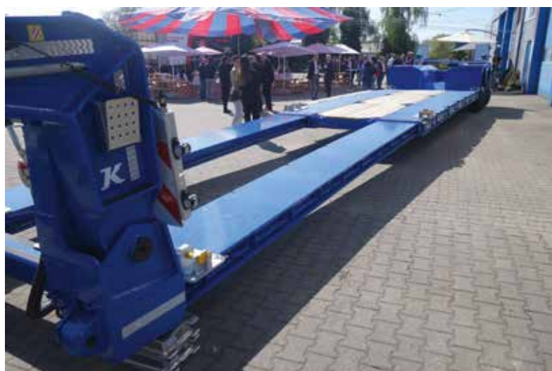
Für den Transport langer Ladungen ist der Tieflader teleskopierbar.
