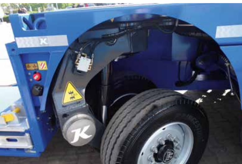
Technik im Detail: Der Achsschenkel samt Hydraulikzylinder ist eine komplette Eigenentwicklung von Kässbohrer.
