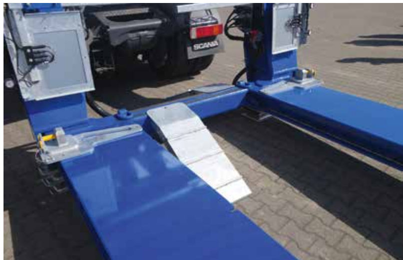
Für schnelle und ergonomische Arbeitsabläufe ist der Kässbohrer Pendel-Tieflader SLL P mit einem abnehmbaren Schwanenhals ausgestattet, der mit Rampen eine Beladung von vorne ermöglicht. STM-Bild
