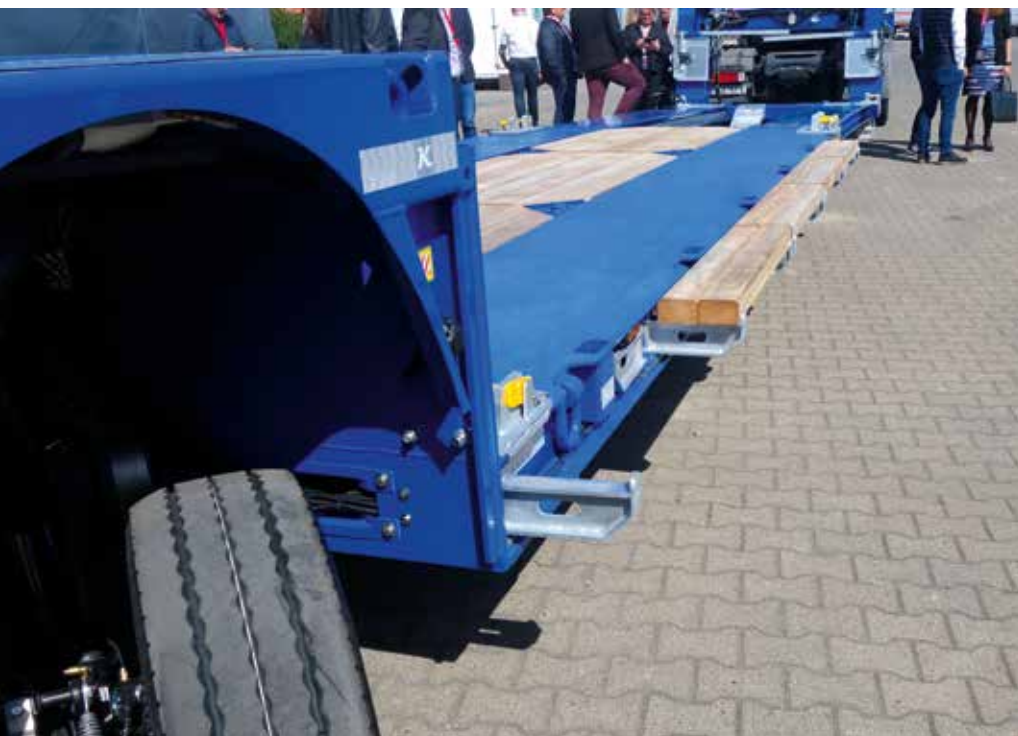
Der Kässbohrer Pendel-Tieflader SLL P kann auf beiden Seiten um 230 mm verbreitert werden. STM-Bild
