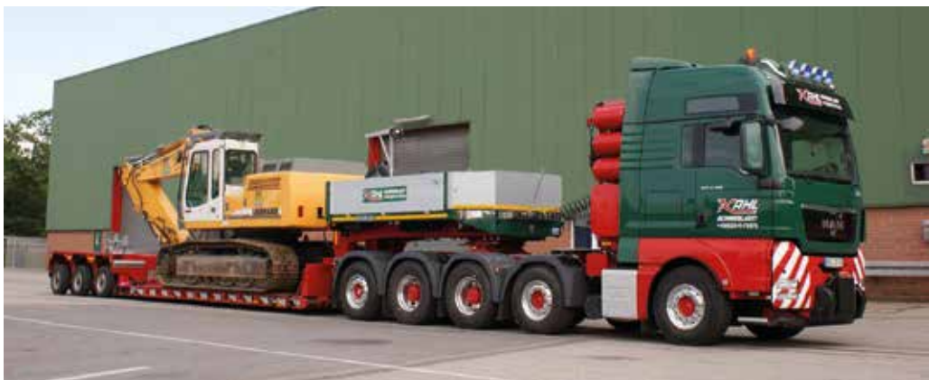
Auf der BAUMA 2010 wurde ein 5-Achser auf Basis eines MAN TGX 41.680 mit 52 Tonnen Gesamtgewicht und 500 Tonnen Gesamtzuggewicht mit einem eigens entwickelten 3-Achs-Tiefbett vorgestellt.
