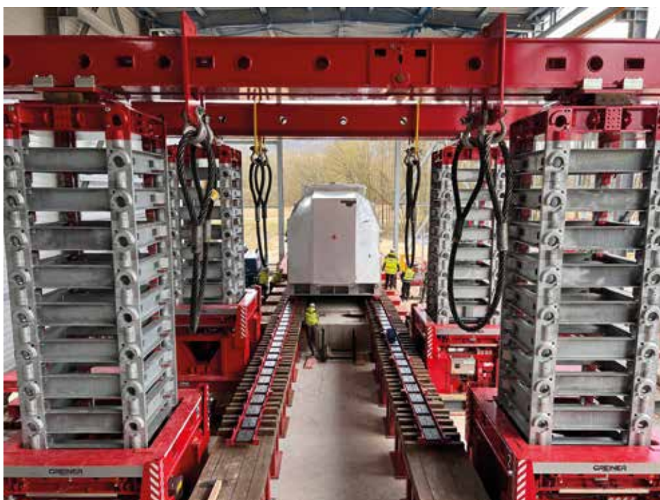
Mit den Jack-up-Systemen können Lasten ohne Kran in die Höhe gebracht werden.
