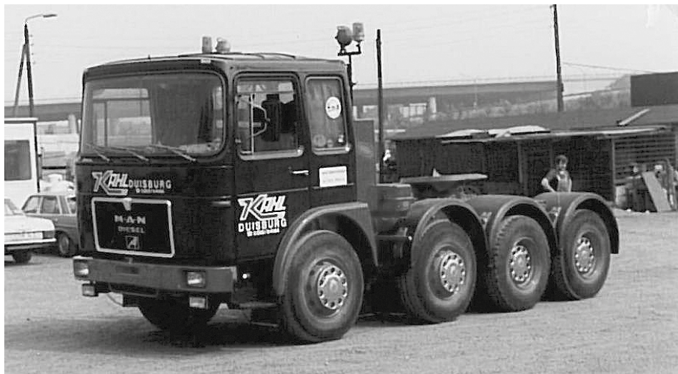
Marke Eigenbau im Jahr 1981: KAHL baute einen dreiachsigen MAN zu einer 4-achsigen Schwerlastzugmaschine um.
