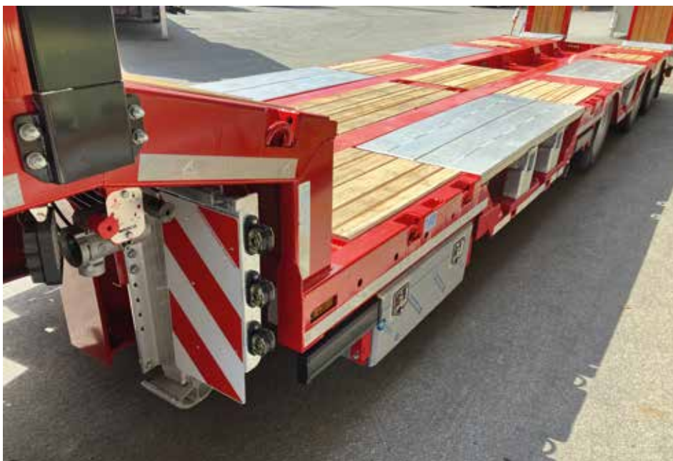
Zu den Ausstattungsmerkmalen zählen beispielsweise Baggerstielmulde oder abdeckbare Radmulden.
