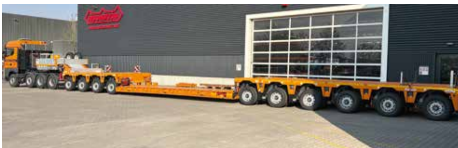
Mit dem ebenfalls neuen 4-Achs-Dolly-Fahrwerk wird aus dem 4+6-Achs-Tiefbett ein 10-achsiger Semi-Satteltieflader.
