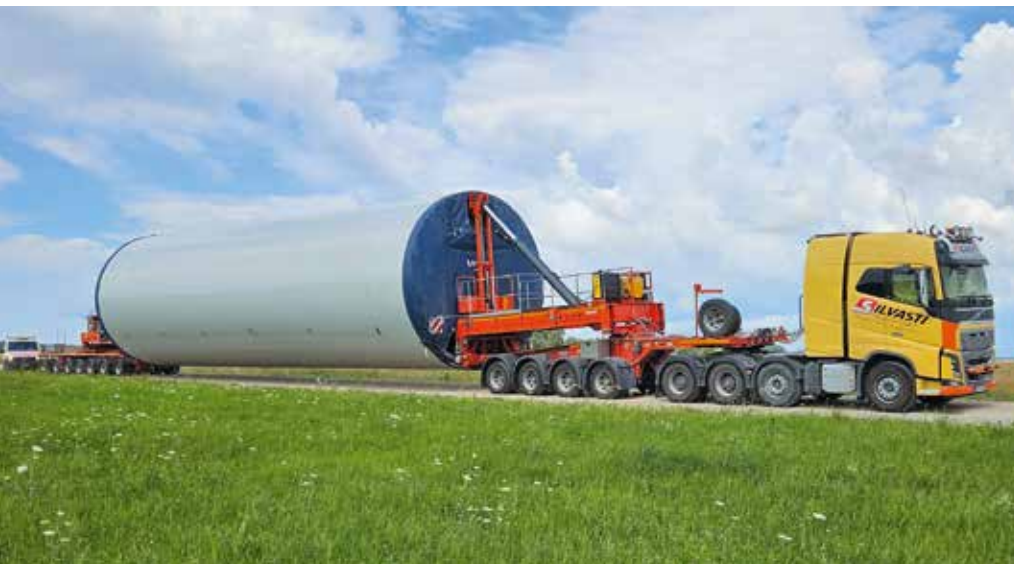
Während eines Projektes in Litauen setzte Silvast den MWT-XXL für den Transport von Turmsegmenten mit einem Außendurchmesser von 6,3 Metern ein.
