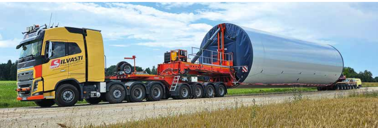
Ein großer Unterschied zu anderen Turmadapter: Anstelle einer 4-Punkt- kommt beim MWT-XXL eine 3-Punkt-Klemmung zum Einsatz.
