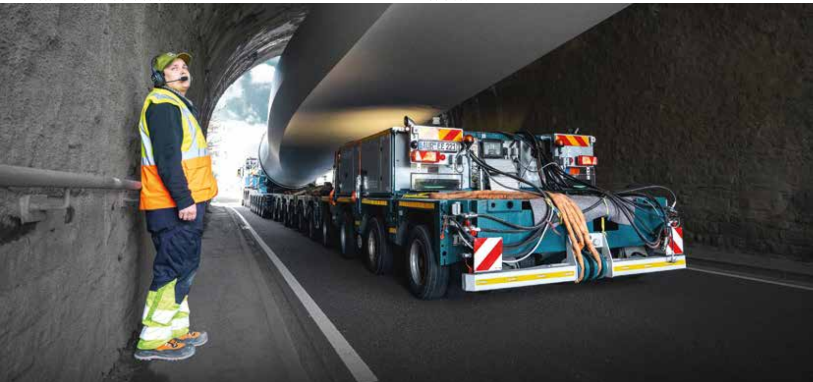
Millimeterarbeit im Detail: Beim Durchfahren von Unterführungen und Engstellen ist exakte Abstimmung zwischen allen Teammitgliedern entscheidend.
