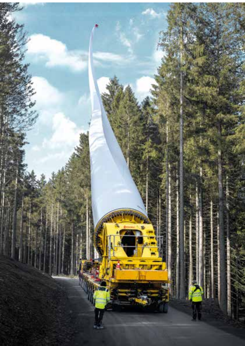
Durch das Anheben des Rotorblatts können Hindernisse wie Bäume oder Infrastruktur gezielt überwunden werden. SCHEUERLE Bladelifter haben einen Aufstellwinkel von bis zu 60 Grad.
