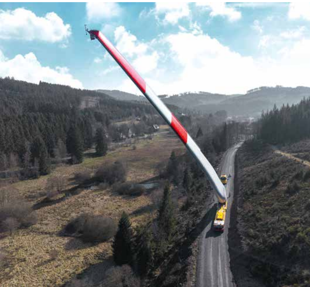
86 Meter lang: Die Rotorblätter des Typs E-175 EP5 E1 stellen höchste Anforderungen an Transportlogistik und Streckenplanung.
