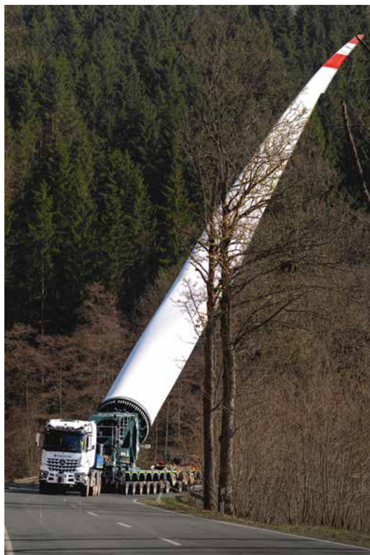
Anpassungsfähig entlang der Strecke: Der Aufstellwinkel des Rotorblatts variiert je nach Abschnitt zwischen 21 und 46 Grad – möglich sind bis zu 60 Grad.
