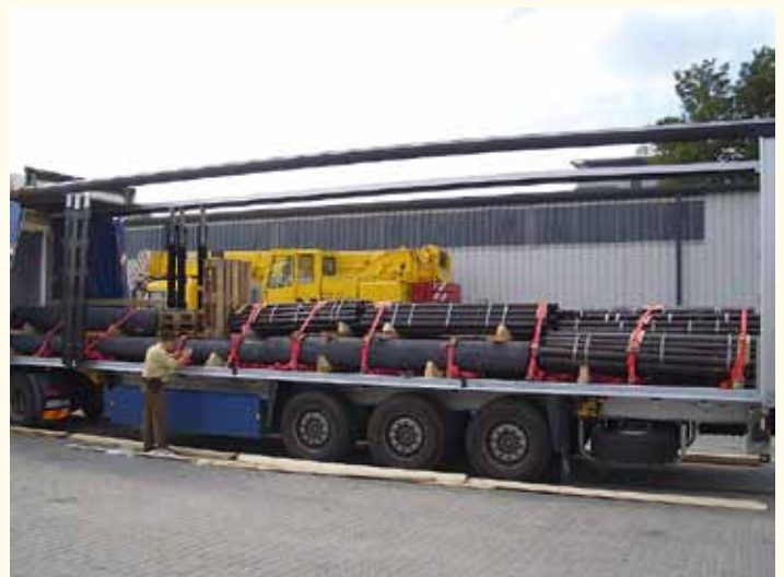
... und anschließend mit Zurrgurten korrekt gesichert. Gut zu sehen: Mit Hilfe von Europaletten wird eine formschlüssige Ladungssicherung erreicht.
