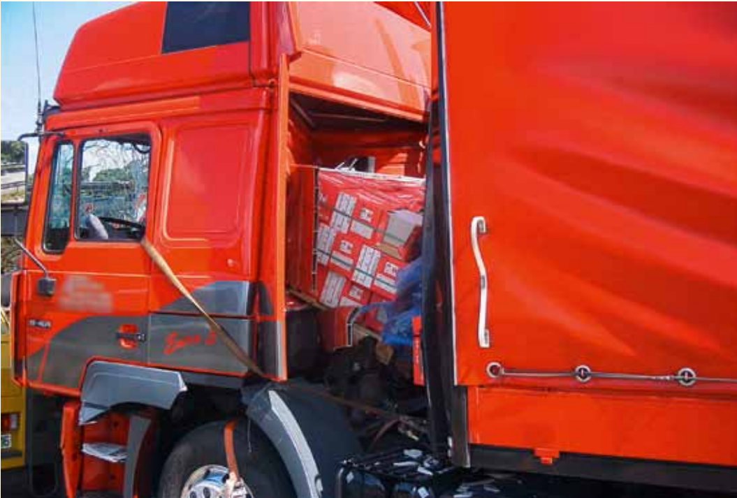
Hier hat es die Ladung durch die Stirnwand gedrückt. Im schlimmsten Fall kann die Kabine für den Fahrer zur tödlichen Falle werden.
