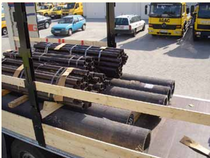
Alltäglicher Grusel auf deutschen Straßen: von Ladungssicherung keine Spur. Zum Glück wurde diese tickende Zeitbombe von der Polizei aus dem Verkehr gezogen ...
