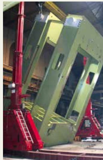
Zur Montage beim Endkunden kam ein Schwerlasthubgerüst zum Einsatz.
