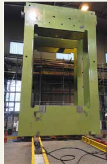
Zur Montage beim Endkunden kam ein Schwerlasthubgerüst zum Einsatz.
