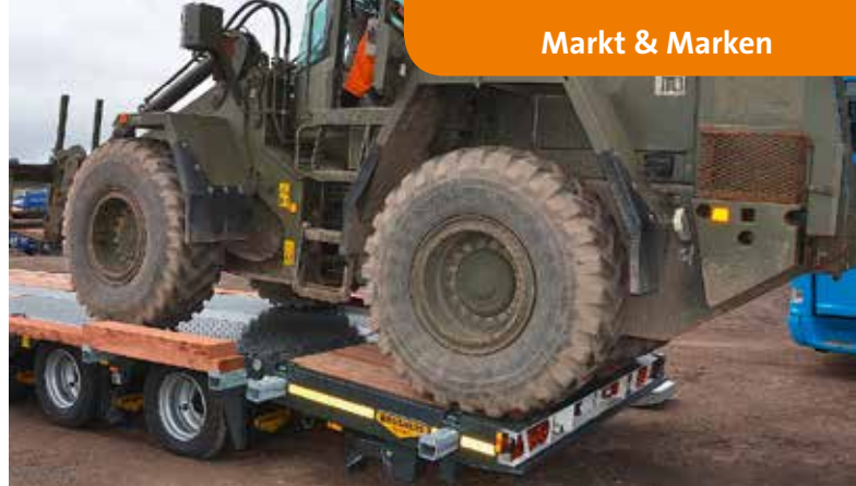
Der Be- und Entladungsvorgang gestaltet sich einfacher und benötigt weniger Platz. Es ist möglich, mit 24 t über die Rampen zu fahren.
