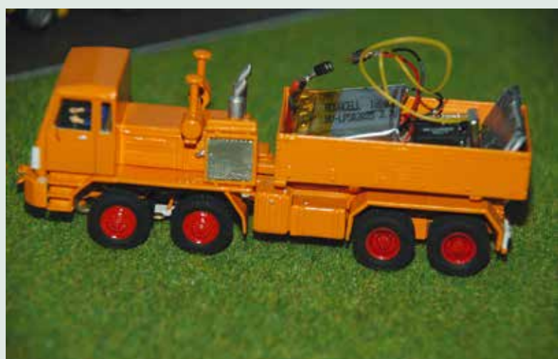
Lipo-Akku und Empfänger sind auf der Ballastpritsche zu finden.
