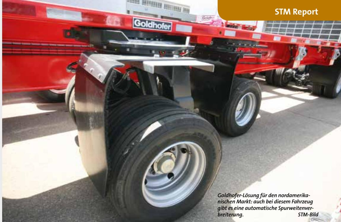
Goldhofer-Lösung für den nordamerikanischen Markt: auch bei diesem Fahrzeug gibt es eine automatische Spurweitenverbreiterung. STM-Bild
