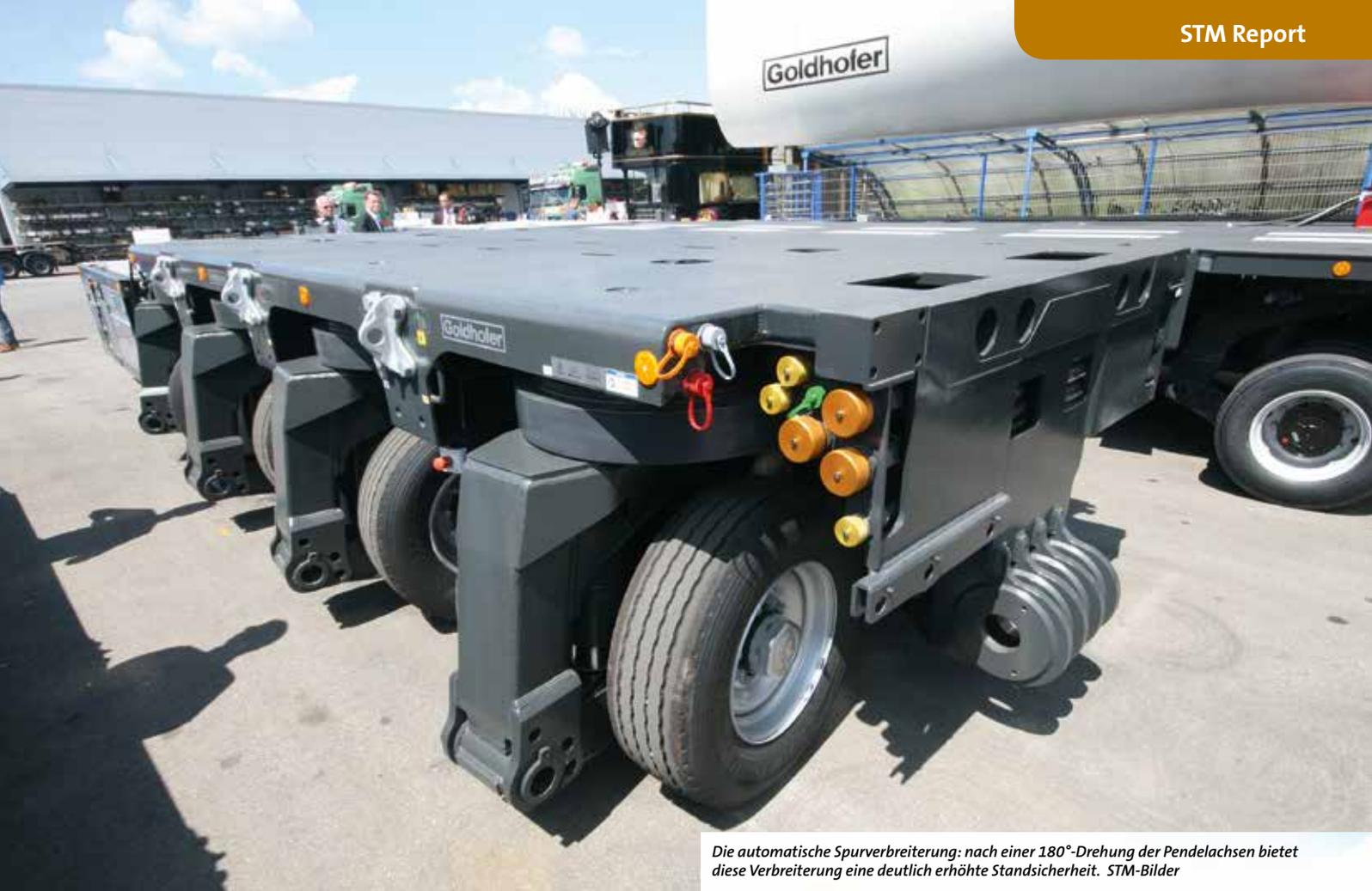
Die automatische Spurverbreiterung: nach einer 180°-Drehung der Pendelachsen bietet diese Verbreiterung eine deutlich erhöhte Standsicherheit. STM-Bilder
