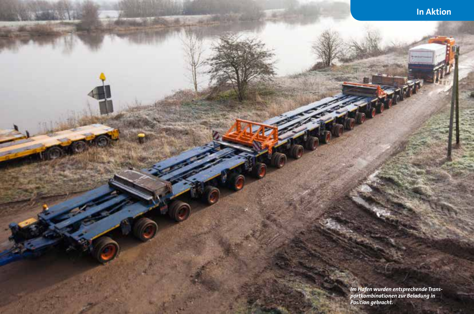
... und wird auf dem Anhänger (bestehend aus 20 Modulachsen) positioniert.
