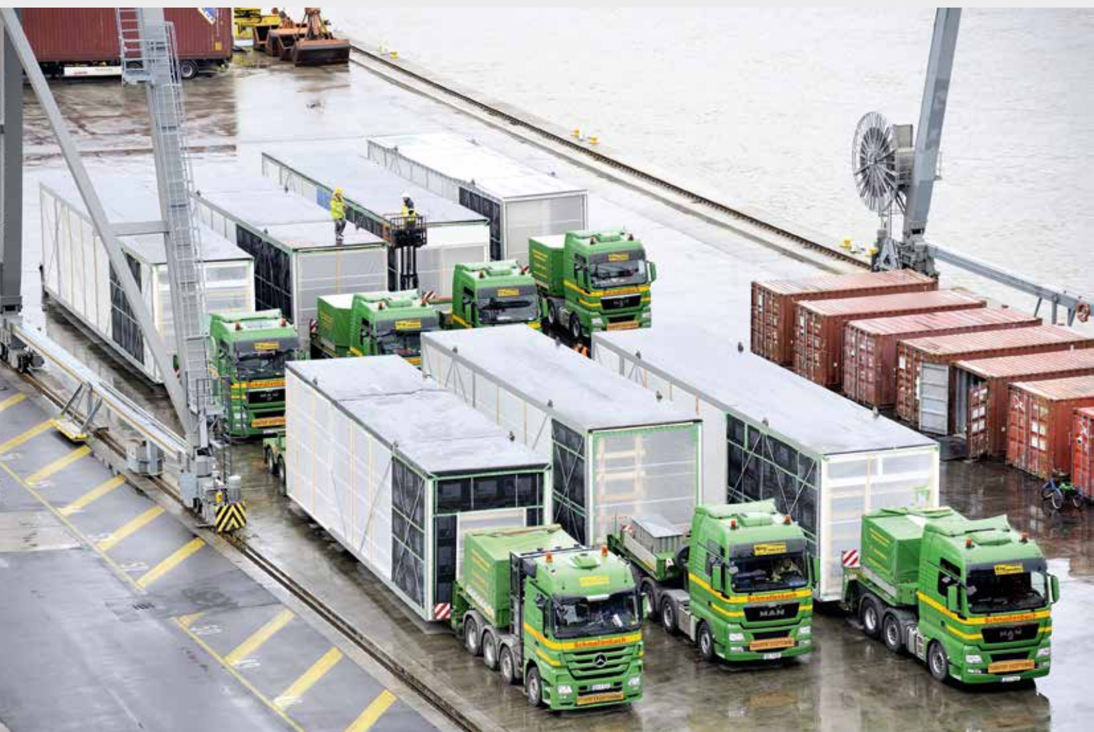
BigMover Schmallenbach beim Umschlag von Raummodulen im Rheinhafen Bonn für eine Schweizer Großbaustelle.
